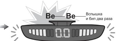
Включите зажигание, переместите ручку коробки передач из позиции N в позицию R 10 раз с интервалом в 1 сек. На 10-ый раз останьтесь в позиции R на 6 сек. Это активизирует функцию запоминания и система больше не будет реагировать на выносной элемент автомобиля. Включите зажигание, переместите ручку коробки передач из позиции N в позицию R 12 раз с интервалом в 1 сек. На 12-ый раз останьтесь в позиции R на 8 сек. Это обнулит функцию запоминания.
