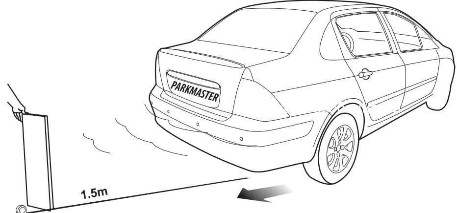
Данный тест возможен с применением плоской деревянной доски размерами 30x100см: держите ее позади автомобиля и двигайтесь задним ходом для проверки каждого датчика системы, как показано на рисунке.
