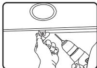
Выбрать место выше номера и бурить отверстие что бы зафиксировать с одной стороны Мисго Таб камеру, и вставить камеру в отверстие.
