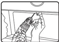
Зафиксируйте другую сторону камеры болтом.
